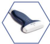
**Sonda SL3-19X** de 256 cristales y tecnología SEAMLESS (continuo, sin bordes, ni membrana) y amplio cabezal. Con un cristal único superior **X+ Crystal Signature™**. De 3 a 19MHz.
