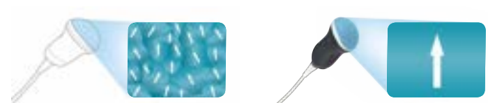
Tecnología PZT tradicional: las variaciones de polarización en PZT afectan las propiedades piezoeléctricas y la relación señal-ruido (RSR)
